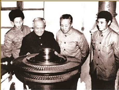
1968年在410厂，师昌绪先生检察用808合金制作的811发动机涡轮盘（左二）
